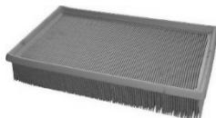
Remplacez le filtre à air par un neuf du bon type. Un filtre à air obstrué augmentera la consommation de carburant et peut même endommager le moteur. Un filtre à air incorrect, perforé ou mal installé peut laisser passer la saleté et la poussière, ce qui entraînera une usure accrue des segments de piston et des roulements..
