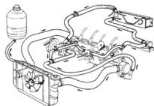
bouchon du radiateur/réservoir d'expansion. Vérifiez les tuyaux d'eau ; remplacez-les s'ils sont perforés ou endommagés. Cela évitera des problèmes à votre client. Installez toujours un nouveau thermostat et utilisez de nouvelles colliers de serrage lorsque les tuyaux d'eau sont remplacés, ce qui assurera une étanchéité correcte. N'oubliez pas de vérifier le refroidisseur EGR.
