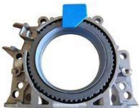
Überprüfen Sie immer den korrekten Kurbelwellen-Positionssensorring! Montieren Sie immer neue Zündkerzen nach den Original-Werksdaten. Das Motormanagementsystem, Modulen und Sensoren sollte überprüft werden, nach Bedarf die defekten Teile austauschen.
