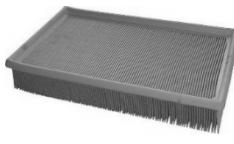
Sustituya el filtro de aire por uno nuevo del tipo correcto. Un filtro de aire obstruido aumentará el consumo de combustible y puede incluso dañar el motor. Un filtro de aire incorrecto, perforado o mal montado puede dejar pasar suciedad y polvo, lo que provocará un mayor desgaste de los anillos y los cojinetes del pistón.
